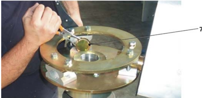
Figura 2-6: Montaggio delle pale disassemblate, inserimento anello di sicurezza.
