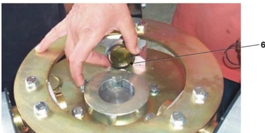
Figura 2-5: Montaggio delle pale disassemblate, regolazione gap.
