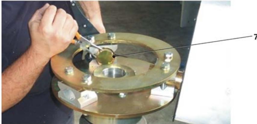
Figura 2-6: Montaggio delle pale disassemblate, inserimento anello di sicurezza.
