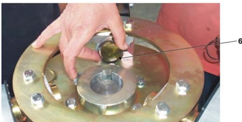
Figura 2-5: Montaggio delle pale disassemblate, regolazione gap.
