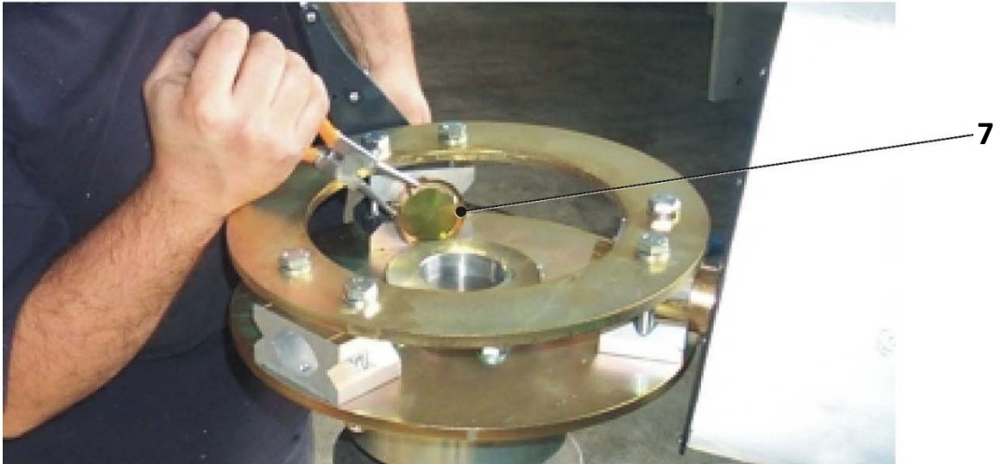
Рисунок 2-4: Сборка лопастей рабочего колеса серии AP
