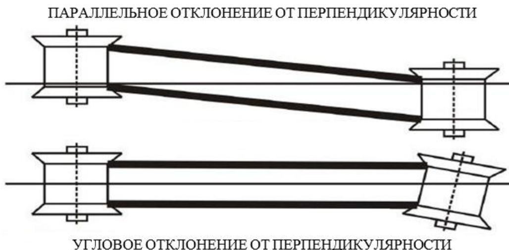
Рисунок 5-4: Типичные варианты отклонения от перпендикулярности осей шкивов к направлению движения ремня для трансмиссии с двумя шкивами
